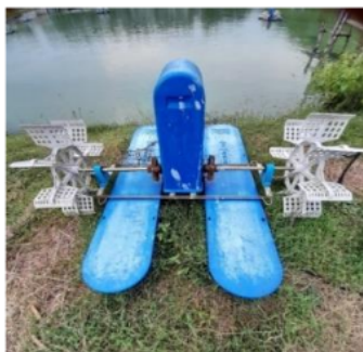
Gambar 1. Kincir air yang digunakan Adapun spesifikasi kincir air dapat dilihat pada tabel dibawah ini.
