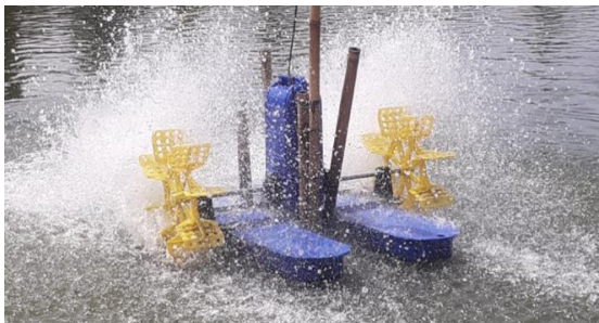
Gambar 2. Aerator paddle wheel dengan transmisi gearbox pabrikan
