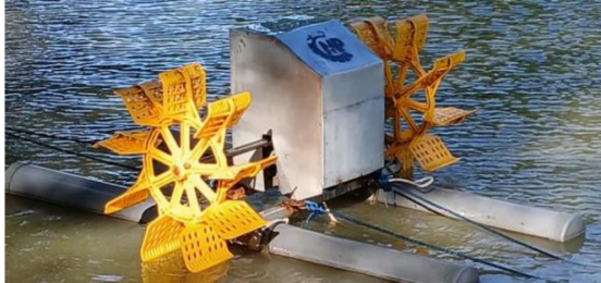
Gambar 1. Aerator paddle wheel dengan transmisi rantai sproket
