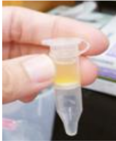
Gambar 4. Penyumbatan ( clogged ) hasil dari proses filter binding pada spin column dengan kit RNAqueous Phenol-free
